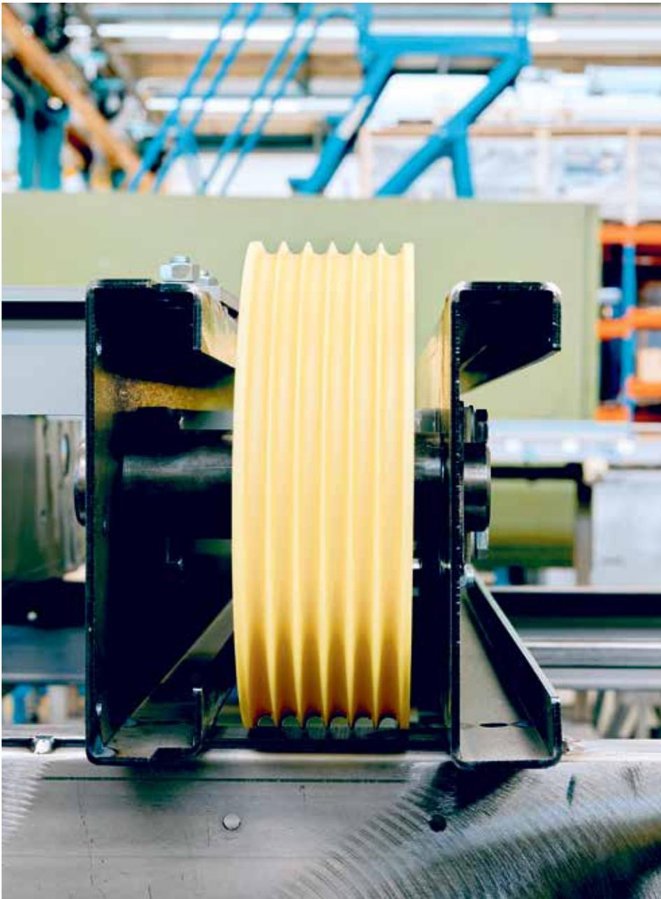
*À gauche: la poulie est conçue de manière à ce qu'un changement de roulement puisse être effectué facilement. À droite: la fabrication à l'unité plutôt qu'en masse apporte qualité et durée de vie.*
