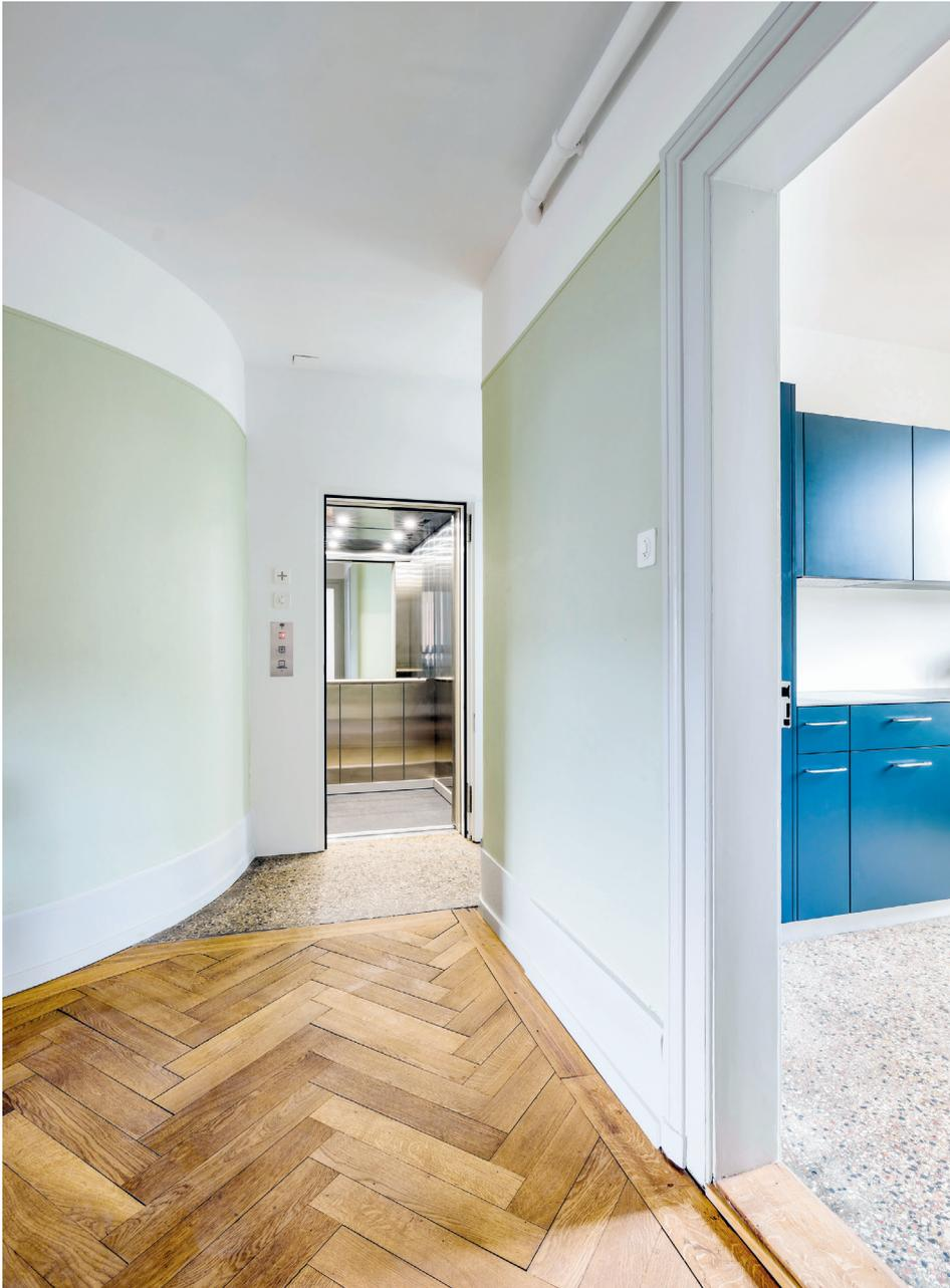
Der Vorschlag löste nicht nur das Lärmproblem, sondern sparte dank der schlanken Konstruktion auch wertvolle Zentimeter ein. Nahezu unsichtbar, versteckt in der historischen Struktur, hat der Lift dennoch eine rollstuhlgängige Türbreite von 80 Zentimetern und eine Innenfläche von 1 auf 1,15 Meter. Die praktische Umsetzung sei eine Herausforderung gewesen, erzählt Stefan Gysel. Das Haus sei alt, die Mauern unter-
